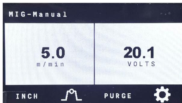
Ruotare l'encoder sinistro (Fig.4, rif. 16) per impostare la velocità di avanzamento del filo e ruotare l'encoder destro
