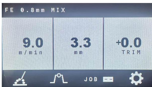
Una volta selezionato un programma, viene visualizzato il programma. La riga superiore del display mostra il nome del programma, il diametro del filo e la miscela gas/gas richiesta. La parte sottostante visualizza, partendo da sinistra, la velocità del filo, lo spessore del materiale e il trim. Sul display di sinistra (Fig.4,rif.15) è presente un amperaggio approssimativo (calcolato in base al materiale, alla velocità del filo, al diametro del filo e ad altre variabili).
