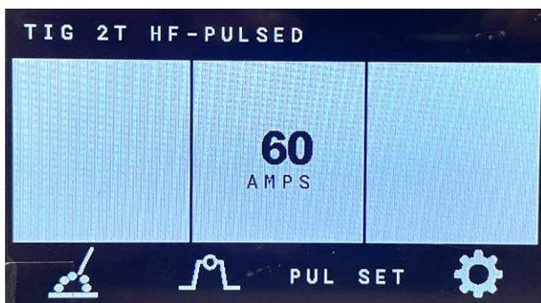
Per regolare i parametri degli impulsi premere il pulsante PUL SET (Fig.4,rif. 10). Con l'encoder (Fig.4,rif. 12) è possibile regolare il valore della
