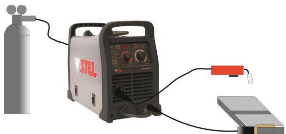
Inserire il filo nel trainafilo facendolo aderire alla gola del rullo (ATTENZIONE: il rullo ha due gole perché girandolo è possibile usarlo per un altro diametro di filo. Vedi paragrafo Rolls Specifications). Quando si cambia la sezione del filo è necessario cambiare: rullo e tubetto portacorrente (è la parte terminale della torcia da cui si vede spuntare il filo).
