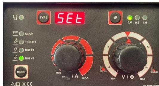
Drücken Sie an dieser Stelle mehrmals die Taste **Ø** (Bez.11), um den BURN-BACK Wert auszuwählen. Der BURN-BACK Wert wird durch das Aufleuchten der Drahdurchmesser-LEDs angezeigt.
