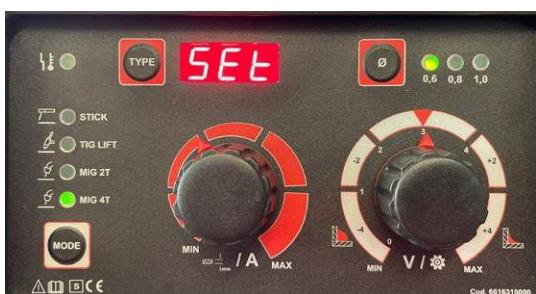
A questo punto premere ripetutamente il pulsante Ø (rif.11) per selezionare il valore di Burn Back. Il valore di Burn Back viene visualizzato attraverso l'accensione dei led del diametro di filo.
