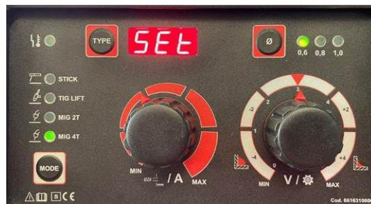
Drücken Sie an dieser Stelle mehrmals die Taste **TYPE** (Bez.13), um die Post-gas Zeit auszuwählen, die auf dem Display angezeigt wird. Es können verschiedene Werte ausgewählt werden. 0,1-2-3-4 Sekunden. Nach dem Einstellen der Post-gas Zeit nach 4 Sekunden beginnt das Display zu blinken und zeigt dann wieder die Materialstärke an.
