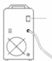
I generatori inverter **TIG uP 403H DC** sono già provvisti del connettore per essere collegato al gruppo A.W.C. Perché il gruppo A.W.C. entri in funzione è necessario accendere sia il generatore, sia il gruppo A.W.C.
